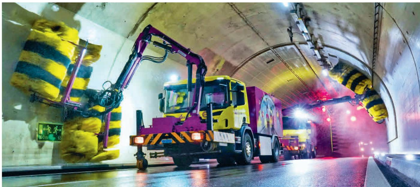
Fahrzeug-Reinigungskonvoi für eine effiziente und hohe Reinigungsleistung
